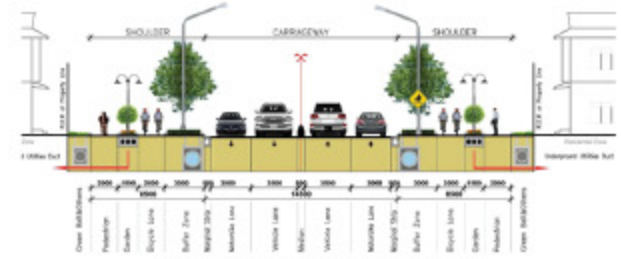
ជំពូកទី១ Class U4 : Arterial / Collector - Four Lanes ( Type B ) ពង្រីក : ១ / ២០០
