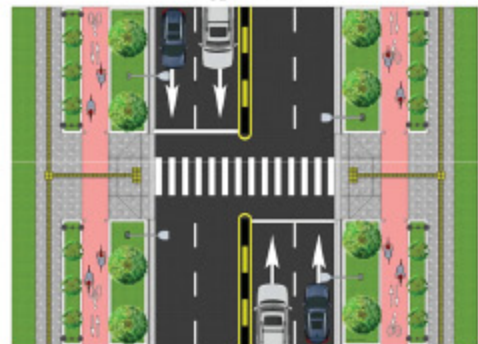
ជំពូកទី២ Class U4 : Arterial / Collector - Four Lanes ( Type B ) ពង្រីក : ១ / ២០០
